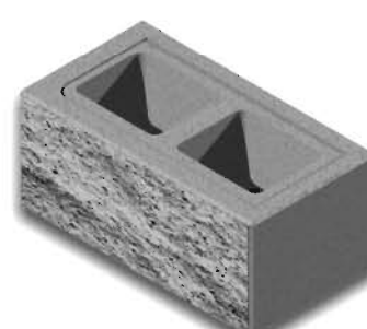
4. PUSTAK ŁUPANY Długość - 38 cm Szerokość - 20 cm Wysokość - 16 cm
